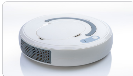
장애물을 감지해 자동으로 방향을 바꾸며 청소하는 로봇 청소기
