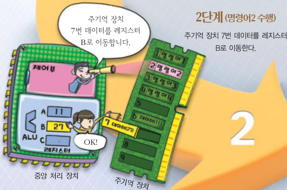
▶ [그림 II-3] 중앙 처리 장치가 두 수에 대한 덧셈을 처리하는 과정
